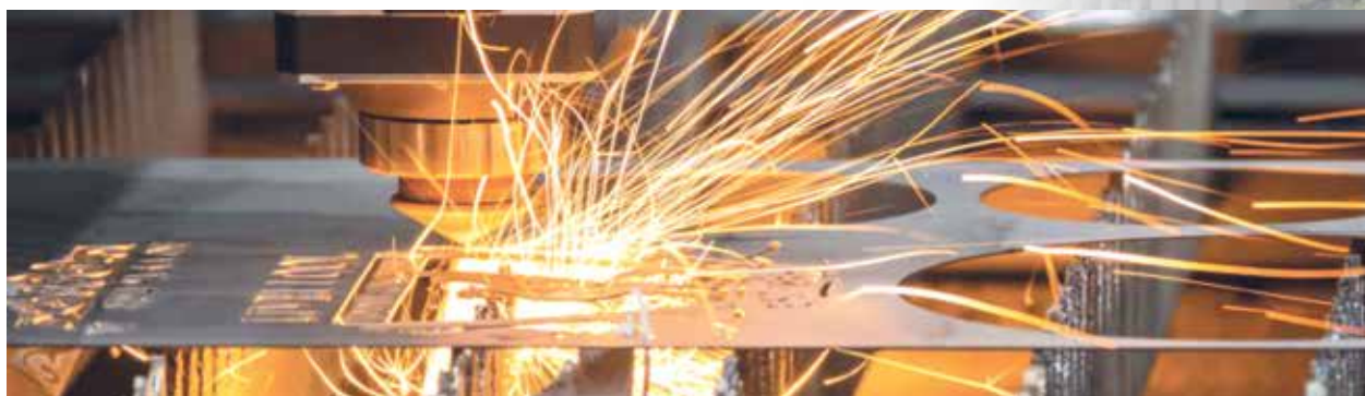
Лазерна різка з ЧПУ. Холоднокатаний метал 2 мм. Покриття порошковою фарбою.
